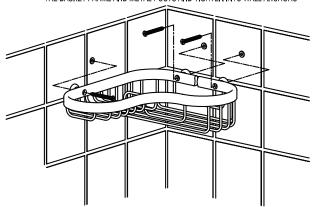
(6) INSERT SCREW COVERS; WETTING THE BLACK RUBBER ON THE COVER WILL MAKE INSERTION EASIER
